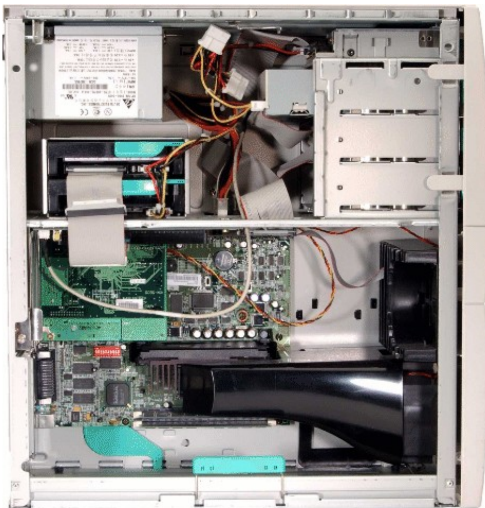
Rysunek 1.1.1. Wnętrze standardowego komputera klasy PC
