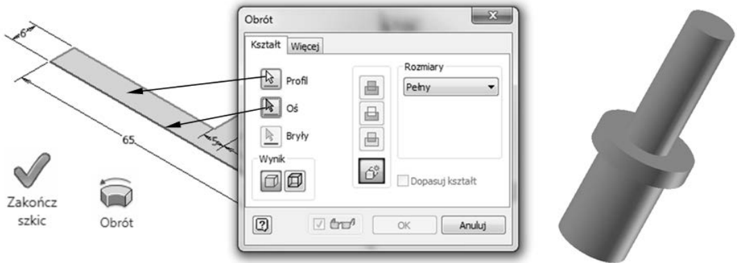
Rysunek 4.11. Obracanie geometrii szkicu wałka
