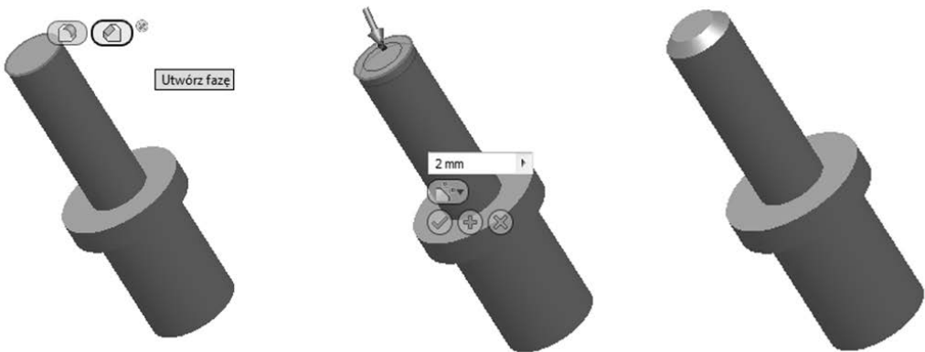
Rysunek 4.12. Ścięcie krawędzi na modelu bryłowym wałka
