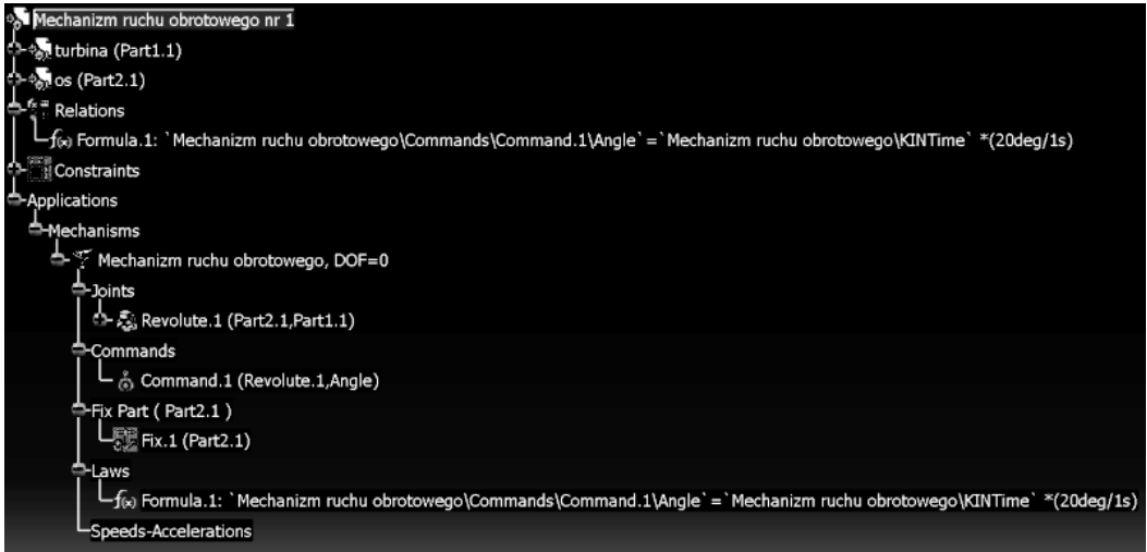
Rysunek 5.34. Widok drzewa topologicznego modelu mechanizmu — widoczne gałęzie zawierające formułę Formula.1
